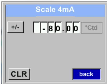
„Scale 4mA“ and „Scale 20mA“ allows defining the desired scaling.
